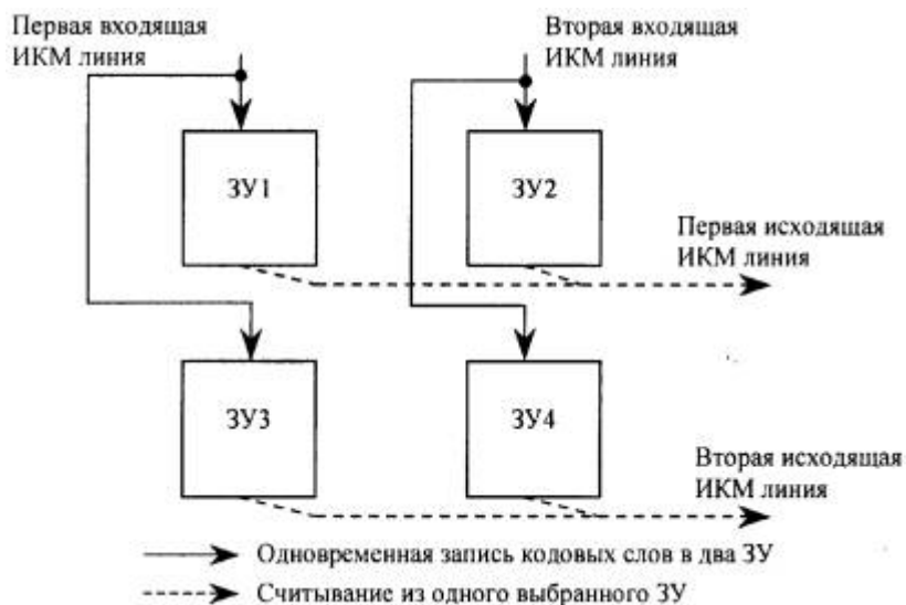
Рис.16. Координатный способ построения S/T-ступени
