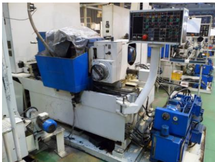
Рисунок 2 – Безцентрово-шліфувальний верстат SWaAKM25/1A для оброблення конічних роликів.
