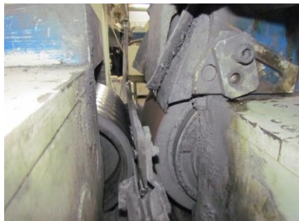
Рисунок 3 – Робоча зона безцентрово-шліфувального верстату SWaAKM25/1A.
