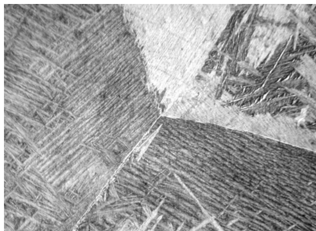
Рис. 3. Микроструктура сплава Zr1Nb после второй ВДП.
