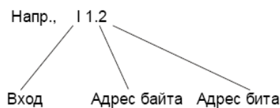
Рис. 22 Адрес входа или выхода цифрового модуля складывается из адреса байта и адреса бита
