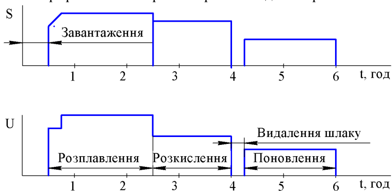
Рисунок 1.12 – Графіки зміни потужності і напруги під час основних операцій у ДСП
