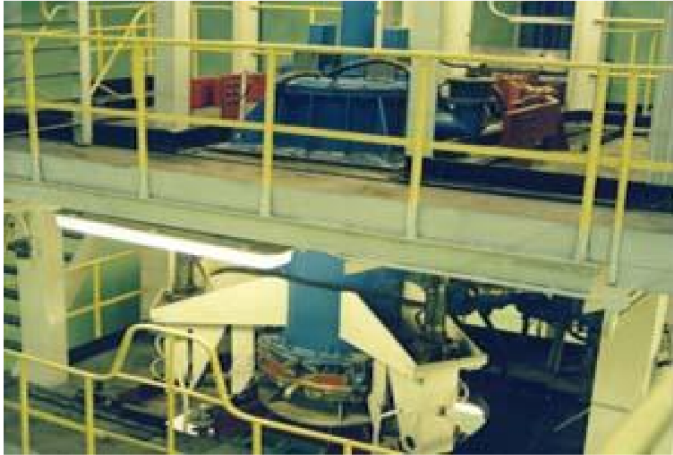
Рисунок 1.20 – Дугова вакуумна піч ДКВ-5,0 [15]
