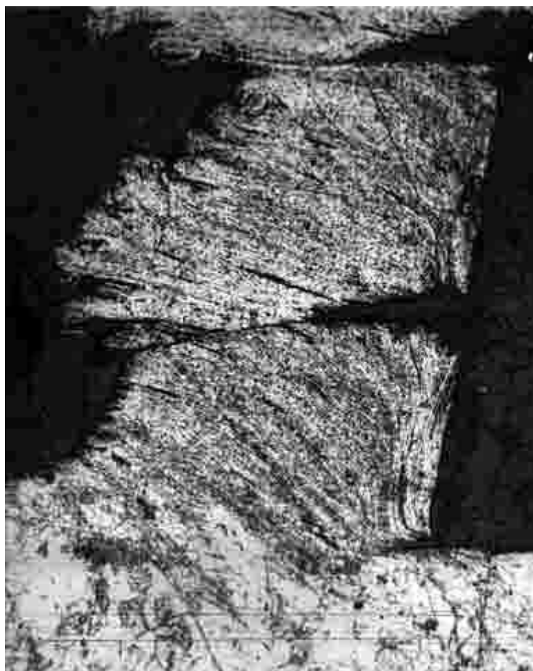
Рис. 4.1. Микрофотография корня стружки скалывания, полученного при резании коррозионностойкой стали 12Х18Н10Т.
